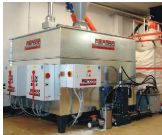
Tandem prensa con dos unidades briqueteadoras para mayor rendimiento con tolva grande (flexible)
