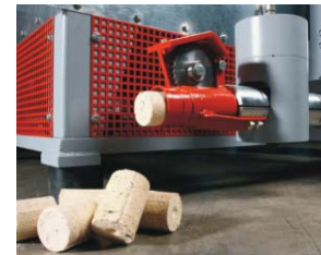
Nuevo: También la serie RB 20 SV - RB 60 SV tiene una vigilancia automática de la longitud de los segmentos
