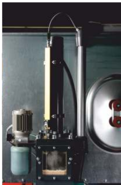
Wegemeßsystem zur Steuerung der Ab- läufe des Zylinders und der Pressmatrize. Daneben die Zentralschmieranlage
